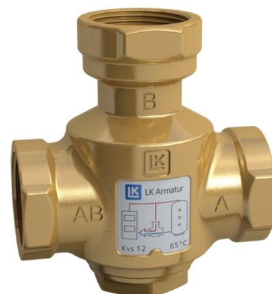
LK 823 ThermoVar® è una valvola anticondensa con funzionamento termostatico a tre vie per il collegamento di caldaie a biomasse con il sistema di accumulo. La valvola è progettata per garantire un'ottimale stratificazione della temperatura nel sistema di accumulo e, contemporaneamente, garantire una elevata temperatura di ritorno verso la caldaia. Questo aumenta l'efficienza del sistema e garantisce una lunga durata della caldaia in quanto riduce la formazione di condensa e catrame.
